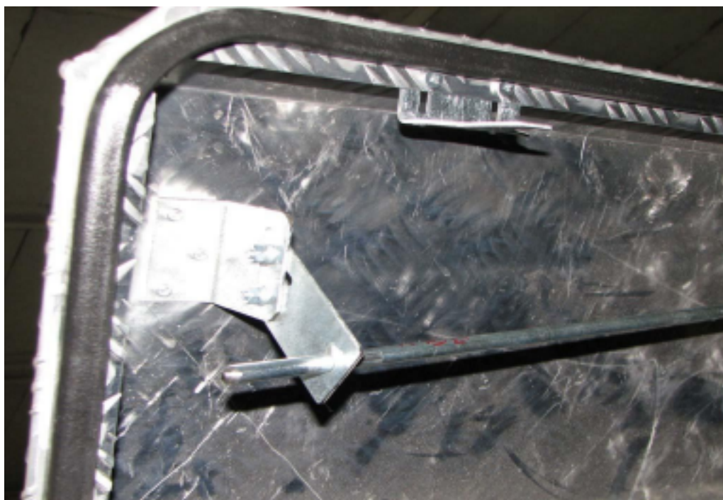
Рис. 6 – Направляющие и наконечники ригеля
